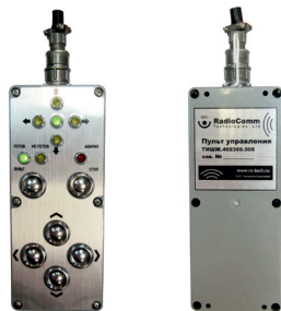
Рис. 6. Пульт управления антенной
